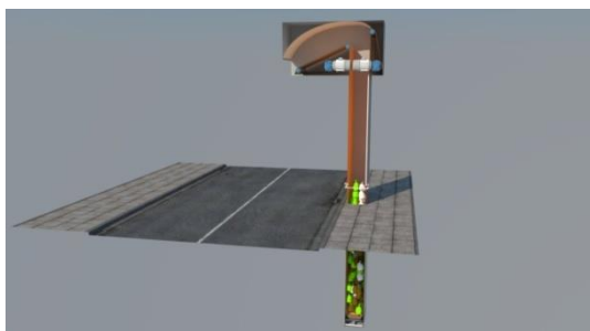
Figura 26: Depósito subterrâneo com resíduos recicláveis pronto para coleta.
