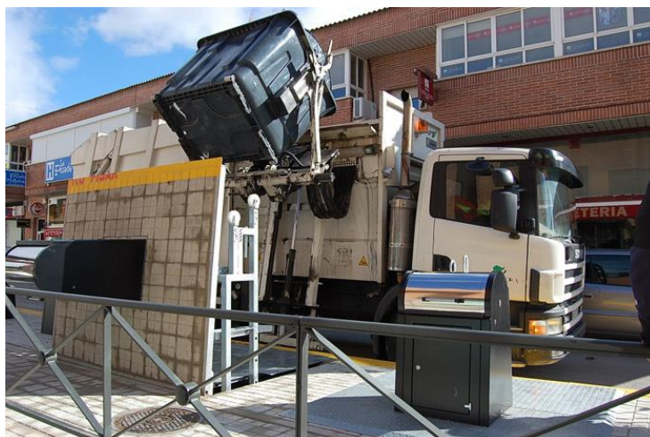
Figura 30: Contêiner sendo descarregado.
